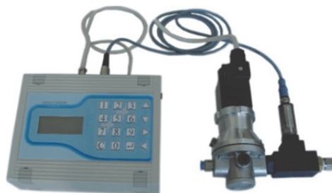
Fig. 2. ME reglare a presiunii hidraulice de acționare, cu supapă ND proporțională, de debit mare.
