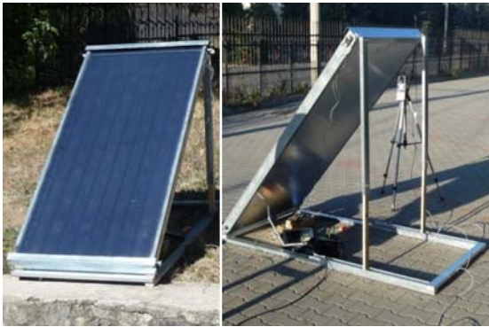
Fig. 3.1. Captatorul termo-solar plan realizat în vederea determinării temperaturii maxime în stare de repaus [4].
