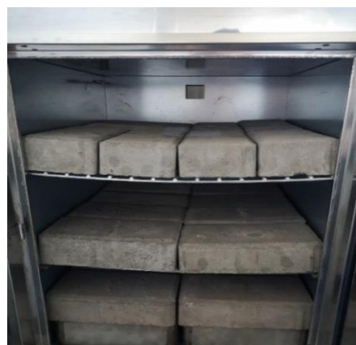
Figura 2.4. Etuvă pentru uscarea pavelor, foto autori.
