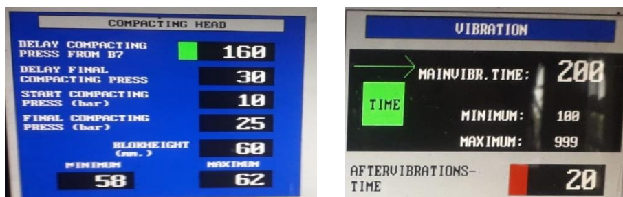
Figura 2.6. Afișarea parametrilor presiune de compactare și timp de compactare pe mașina. Foto autori.
