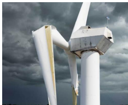
Fig. 1. Locația și aspectul deteriorărilor palelor turbinelor eoliene existente.
