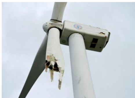
Fig. 1. Locația și aspectul deteriorărilor palelor turbinelor eoliene existente.
