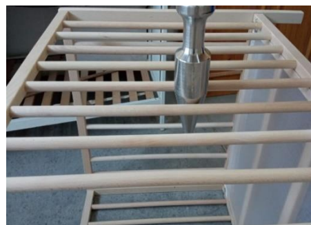
Fig. 2.2. Testul de verificare a rigidității baluștrilor la încovoiere.
