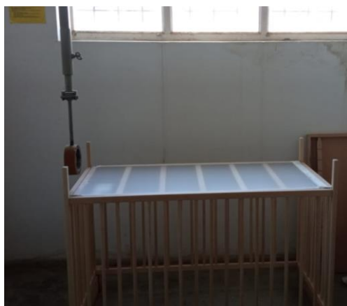
Fig. 2.7. Testul la impact al picioarelor.
