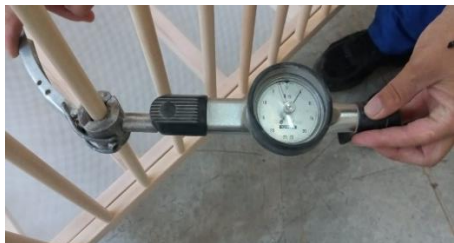
Fig. 2.3. Testul de verificare la răsucire a baluștrilor.
