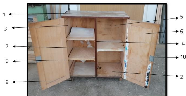
Fig. 3.2. Componentele principale ale comodei și materialele folosite
