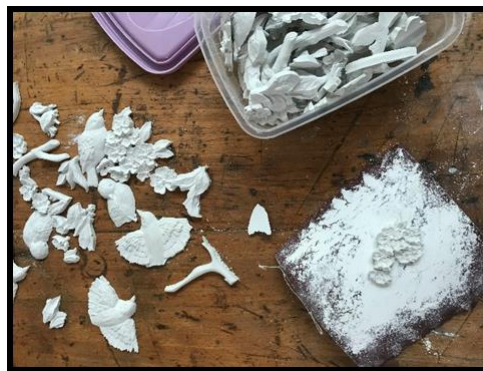
Fig. 3.13. Procesul se șlefuire a formelor din ipsos.
