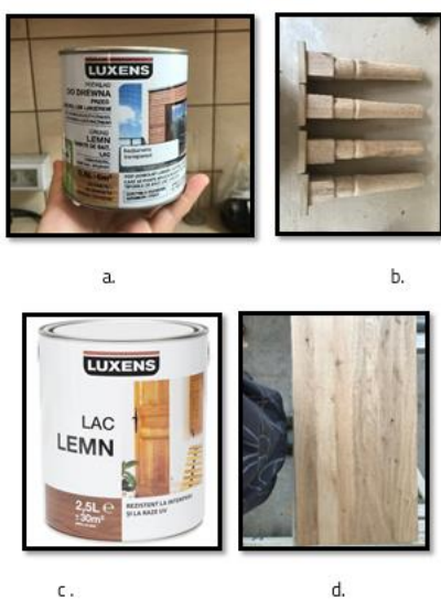
Fig. 3.15. Procesul de finisare transparentă (a – grund hidrodiluabil, b – aplicarea grundului prin pensulare pe picioare, c – lac transparent hidrodiluabil, d – aplicarea lacului prin pensulare pe placa superioară).
