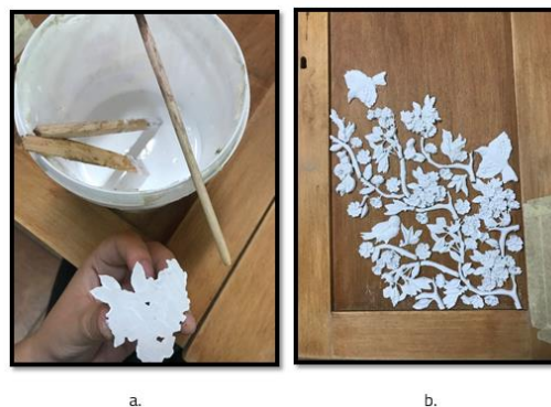
Fig. 3.14. Încleierea formelor decorative (a – aplicarea adezivului, b – formele aplicate pe ușă).
